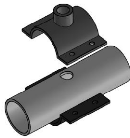
Figura 76 - Orifício de perfuração Ø 20 mm (3/4")
