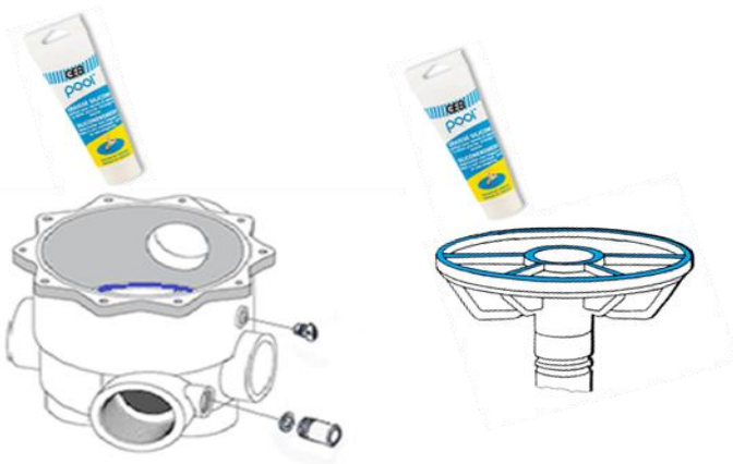
Figura 9 – A lubrificação da vedação e a válvula
